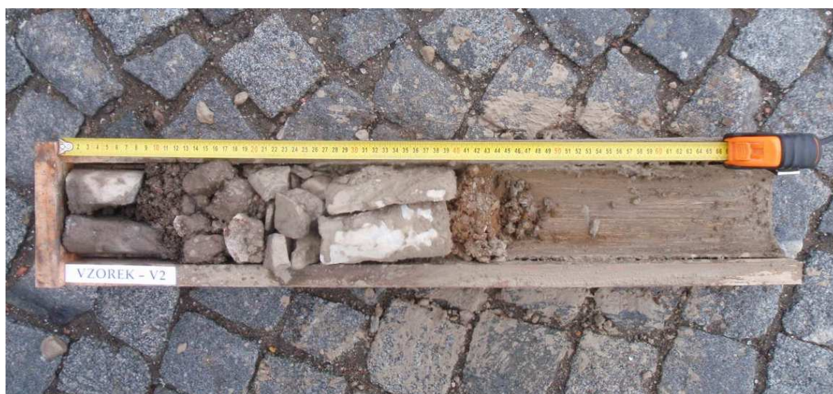
Obr. 3 - Jádro vývrtu Vzorek – V2 (in situ).
