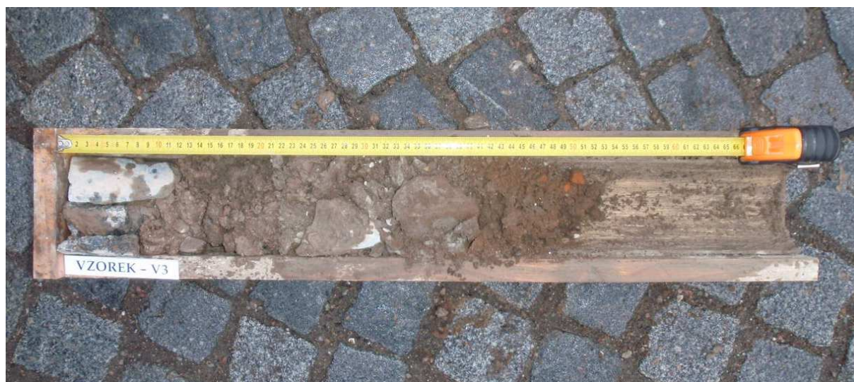
Obr. 5 - Jádru vývrtu Vzorek – V3 (in situ).
