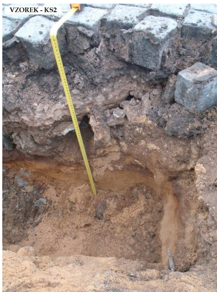
Obr. 8 – Kopaná sonda Vzorek – KS2 (in situ).
