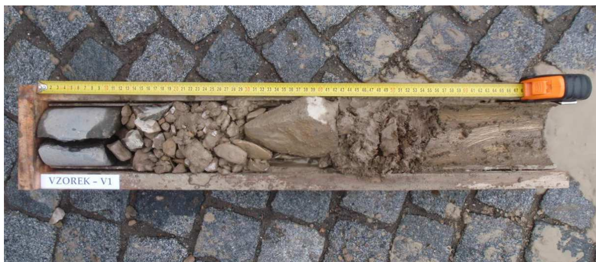
Obr. 1 - Jádro vývrtu Vzorek – V1 (in situ).
